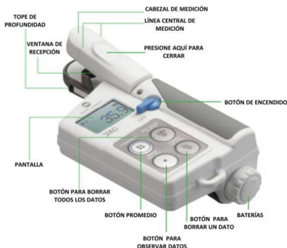
Figura 7 Partes del medidor de clorofila SPAD-502
