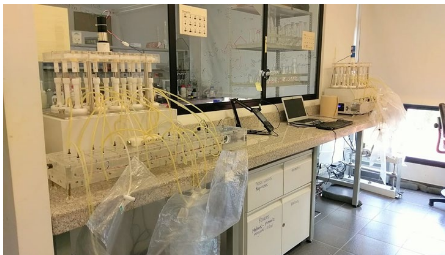
Figura 7 Set para test de potencial de biometano (Anaero Technology, UK).
