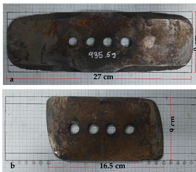
Figura 5.10 Comparación entre desgaste de cuchillas a. Cuchillas desgastadas suelo 10H4 b. Cuchillas desgastadas suelo 6H1
