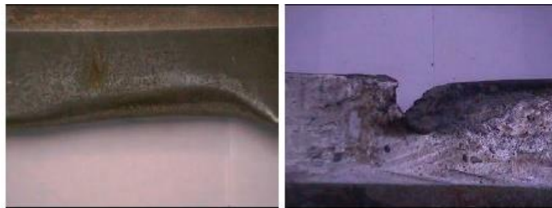
Figura 2.13 Apariencia superficial de cuchillas fabricadas en aceros aleados al cromo manganeso (5)
