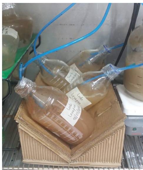
Figura 4. Montaje de reactores con sus réplicas.
