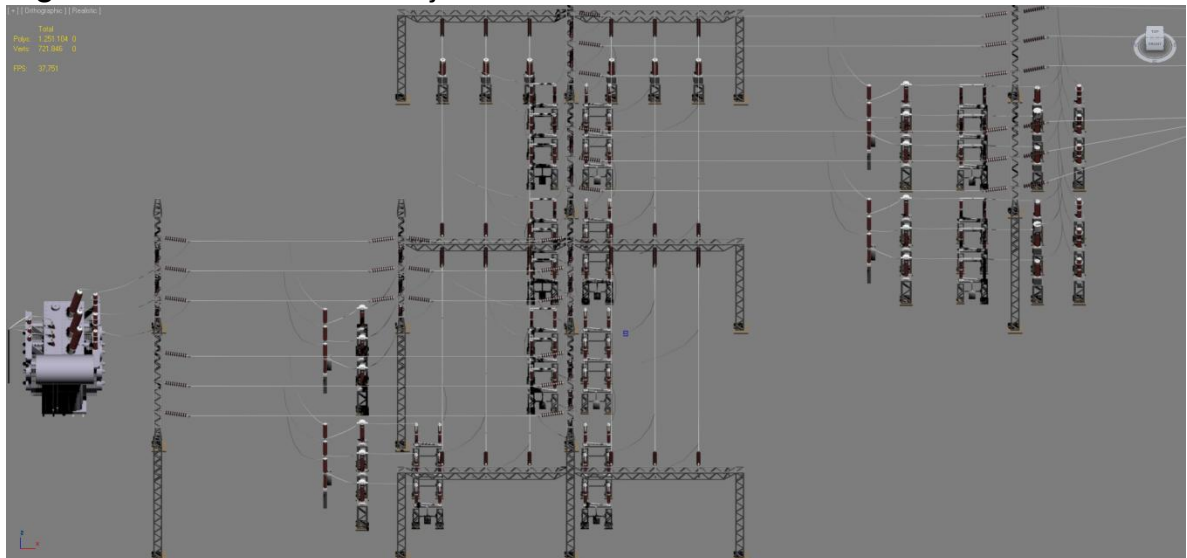
Figura 91. Subestación Barraje Doble en 3ds Max.
