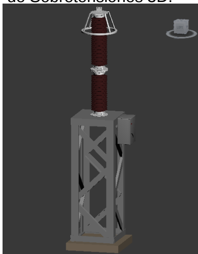
Figura 88. Descargador de Sobretensiones 3D.
