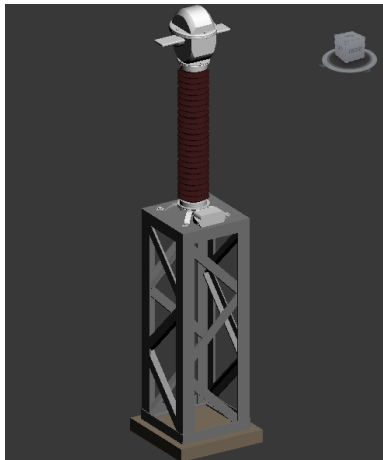
Figura 86. Transformador de Corriente 3D.
