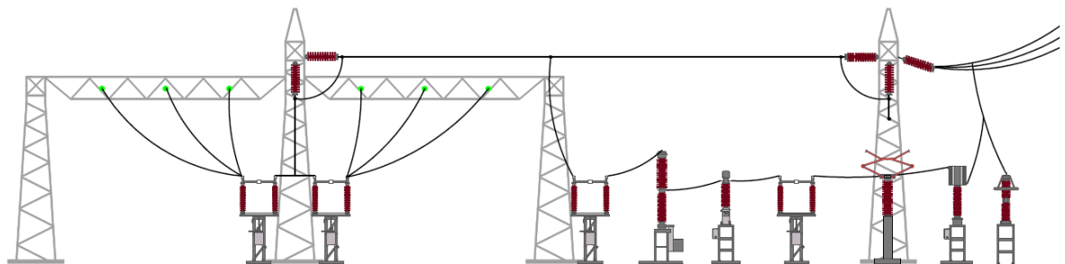
Figura 40. Doble con by-pass, bahía de línea (2-2).
