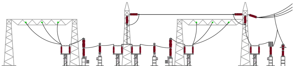
Figura 54. Doble Interruptor, bahía de línea (2-2).
