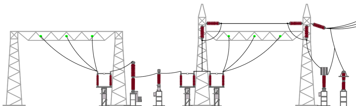
Figura 30. Simple con transferencia, bahía de línea (2-2).
