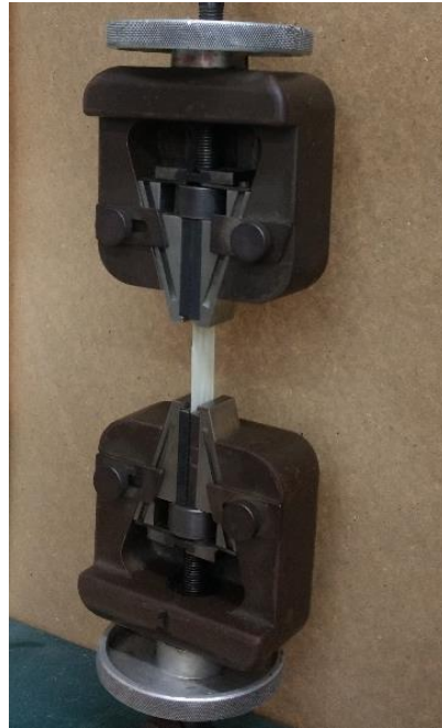
Figura 14. Montaje de ensayos para tensión mecánica.
