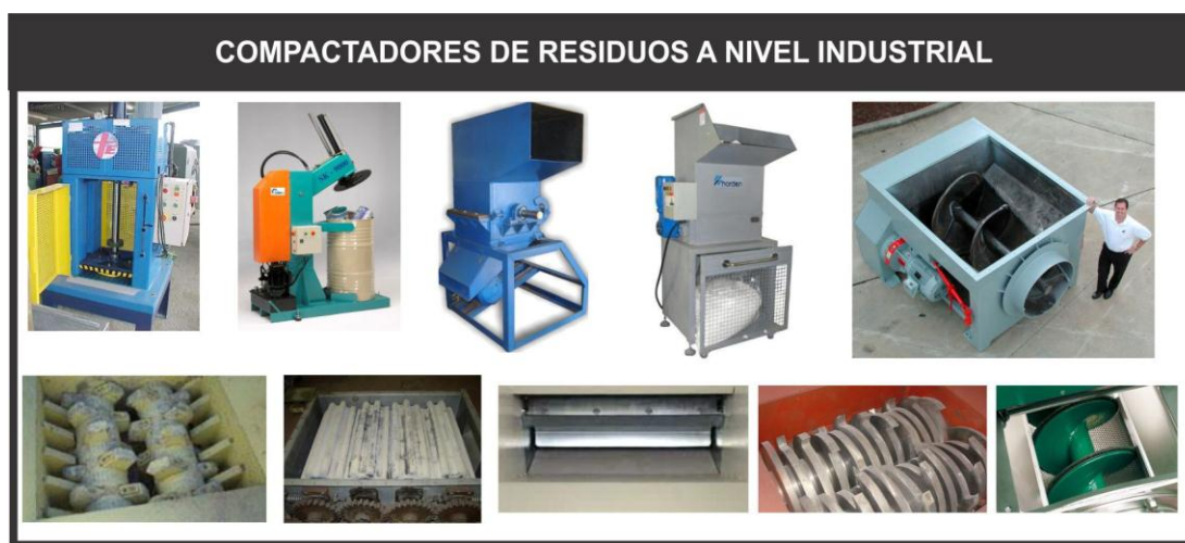
Imagen N° 7 Compactadores de residuos a nivel industrial (mecanismos de compactación)
