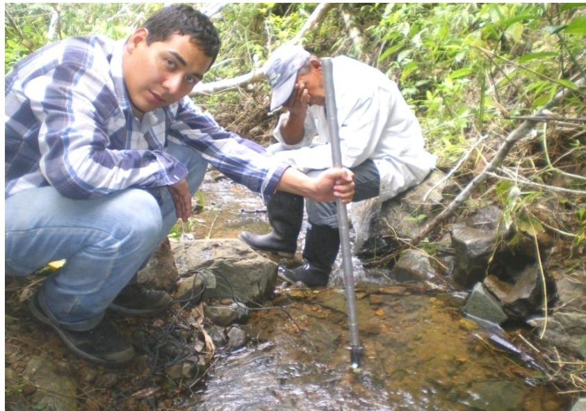
Figura 32. Medición del caudal mediante el método del molinete a la quebrada La Vigía.
