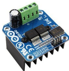
Figura 4.6: Modulo controlador de motor BTS7960 43A
