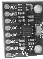
Figura 4.1: Modulo GY521 basado en MPU6050
