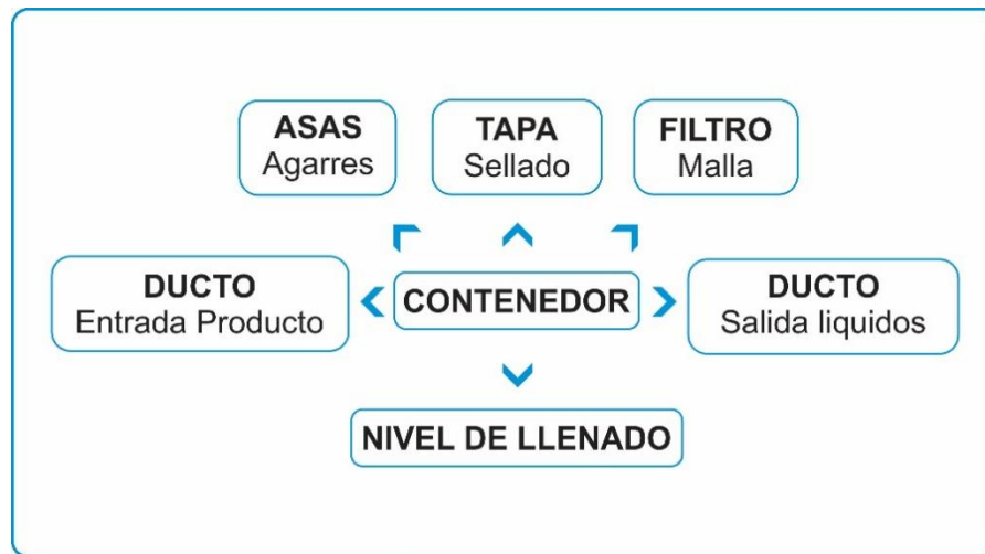
Figura 2: División esquemática del contenedor. Autor
