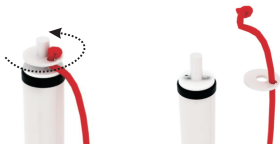
Imagen 72. Imagen que muestra el mecanismo utilizado para sujetar la cuerda y que a su vez permite un giro a 360° en los lanzamientos de la bola.
