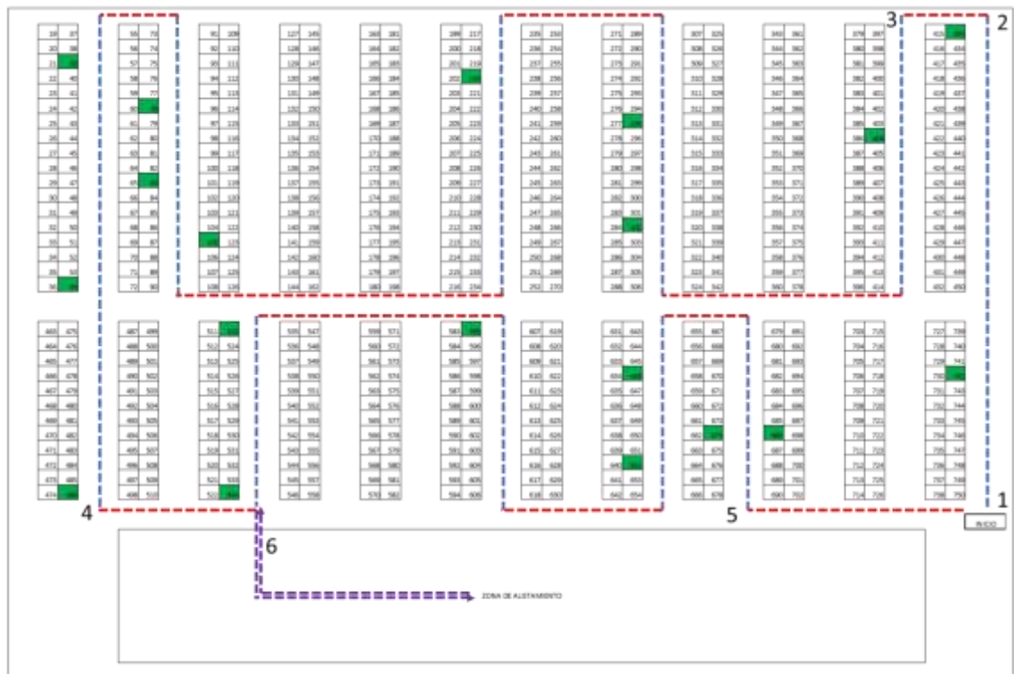
Figura 13. Recorrido S-Shape con validación de capacidad volumétrica. Fuente. Elaboración propia.
