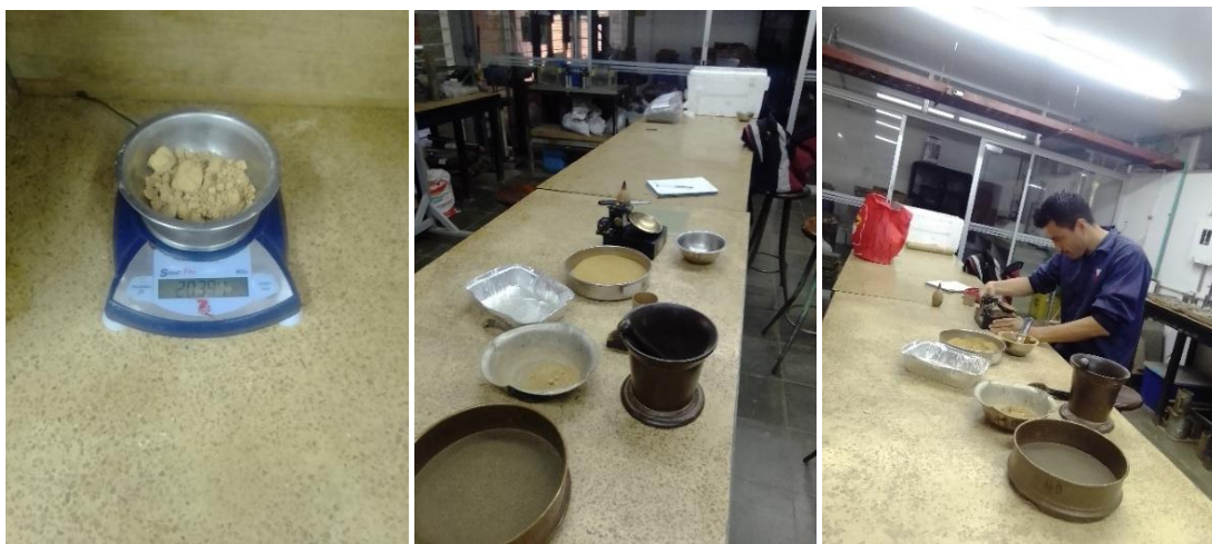
Figura 29. Registro fotográfico. Preparación de muestras para la realización de los ensayos de humedad natural y límites de consistencia. Fuente: Diaz (2023)
