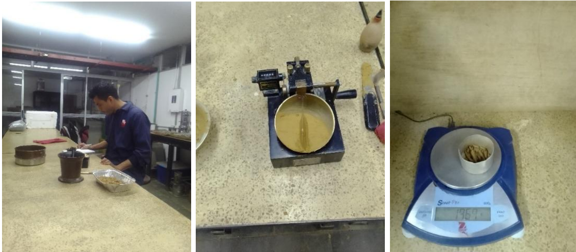
Figura 30. Registro fotográfico. Izquierda. Preparación para Gradación. Derecha Realización Límites de consistencia. Fuente: Diaz (2023)
