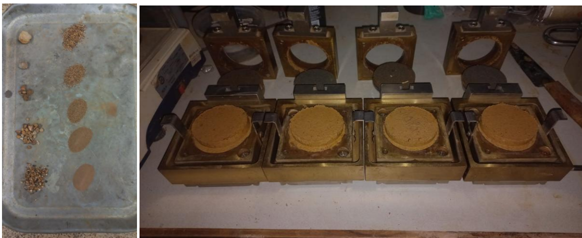
Figura 31. Registro fotográfico. Izquierda gradación suelo, Derecha Probetas para corte directo. Fuente: Diaz (2023)
