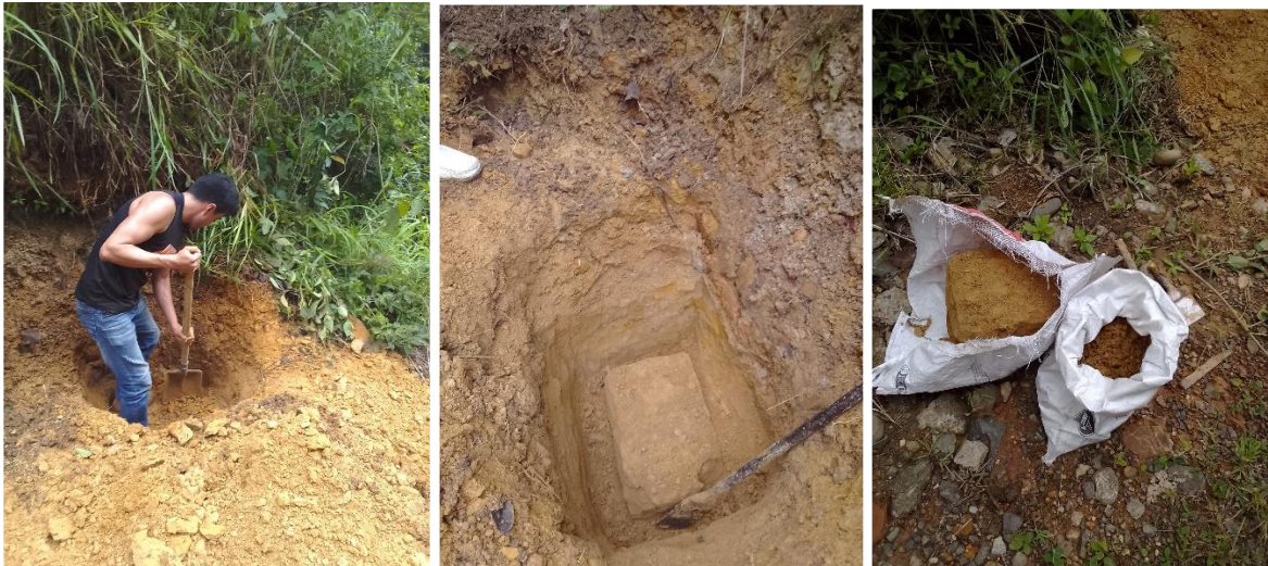
Figura 28. Registro fotográfico. Recolección de muestra inalterada. Fuente: Diaz (2023).
