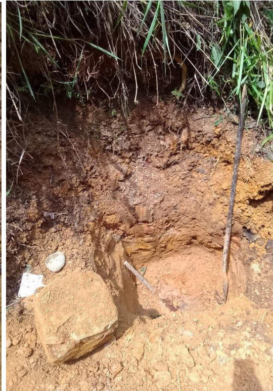
Extracción de muestra en pie de talud. Fuente: Diaz (2023)
