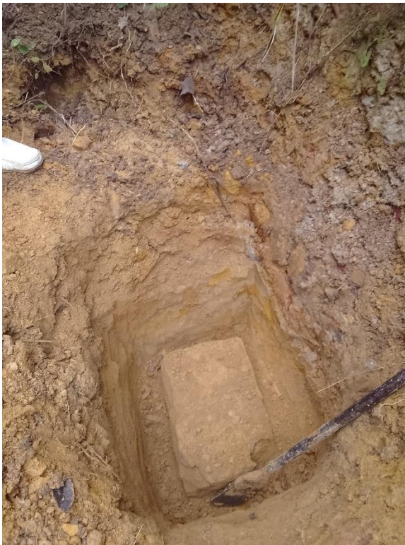
Extracción de muestra en pie de talud. Fuente: Diaz (2023)
