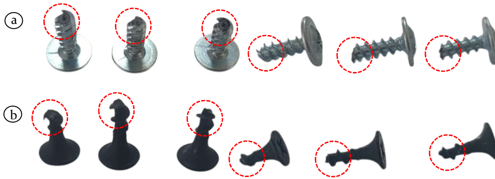
Figura 20. Falla típica a cortante tornillos cabeza plana(a) y drywall (b).
