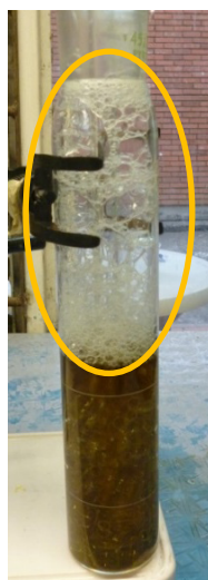
Figura 32. Formación de espuma en los primeros minutos de tratamiento para la ozonización con adición de Fe (II) a pH 3.0.
