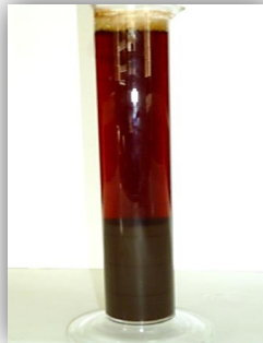
Figura 10. Formación de fases del licor negro en la precipitación ácida.
