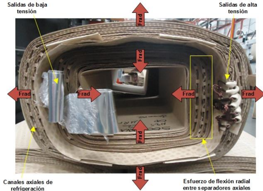
Figura 4.1 Devanados de alta y baja tensión para transformadores con núcleo enrollado (transformador tipo 1).
