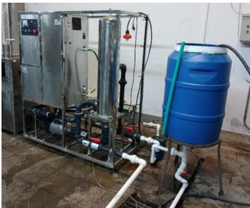
Figura 7. Planta piloto en funcionamiento por lotes para la degradación de IBP.
