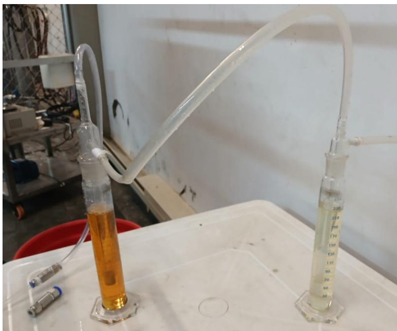
Figura 4. Montaje experimental del proceso de oxidación de yoduro con ozono.
