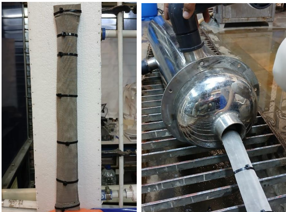
Figura 5. Empaque de carbón activado ingresados al tanque contactor del equipo.
