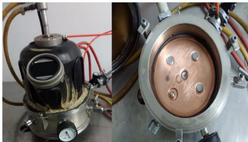
Figura A-2: Horno de arco eléctrico del laboratorio de Espectroscopia Mössbauer del grupo GMTF del Departamento de Física de la Universidad del Valle.
