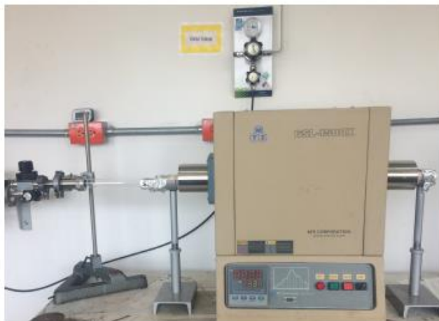
Figura A-4: Horno GSL-1500X del laboratorio de Espectroscopia Mössbauer del grupo GMTF del Departamento de Física de la Universidad del Valle.
