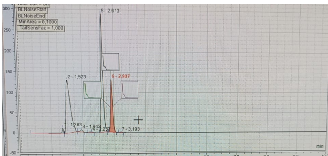
Figura 15. Fotografía de la interfaz del cromatógrafo UHPLC mostrando el cromatograma del ibuprofeno: longitud de onda (264 nm), tiempo de retención (2.907 min) y área (10.5279 mAU*min).
