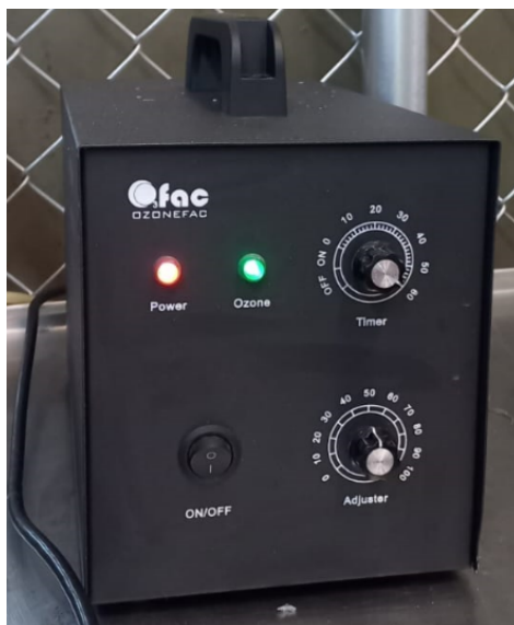
Figura 9. Generador de ozono secundario.
