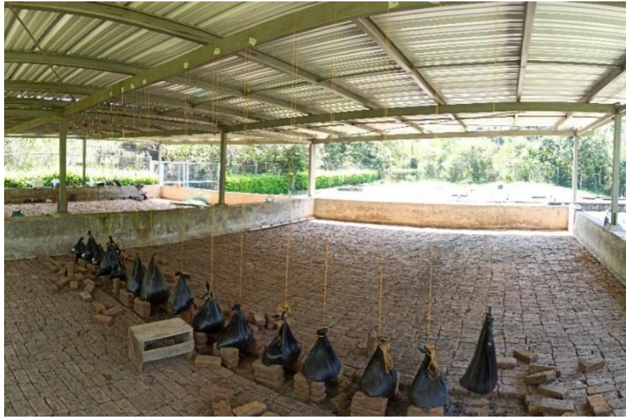
Figura 4. Proceso de secado del material extraído de las trampas de grasas.
