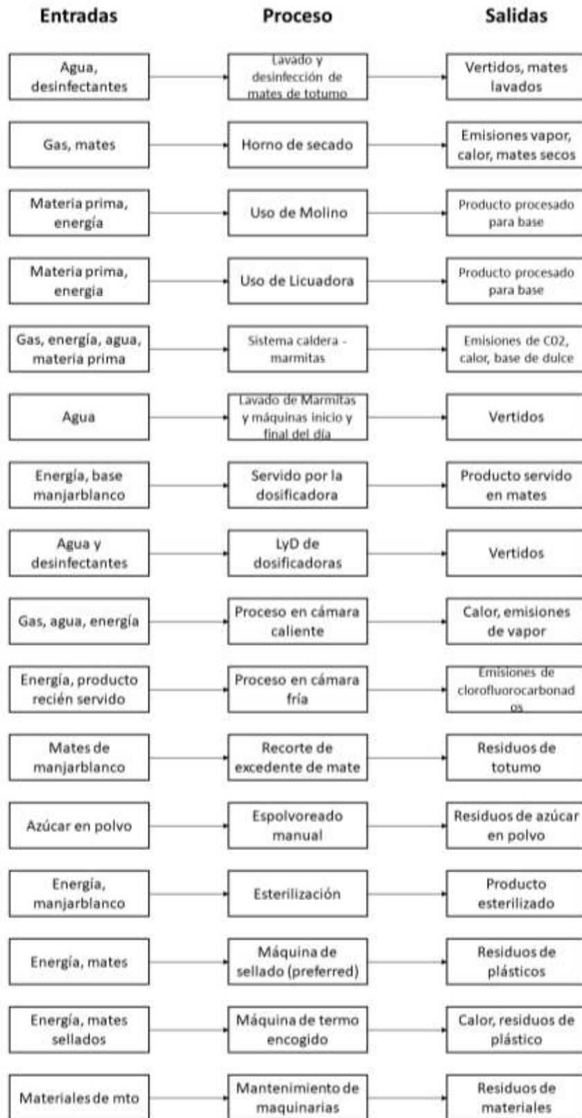
Ilustración 3. Diagrama de entradas y salidas para el proceso de producción de manjarblanco y cortado. Elaboración propia.
