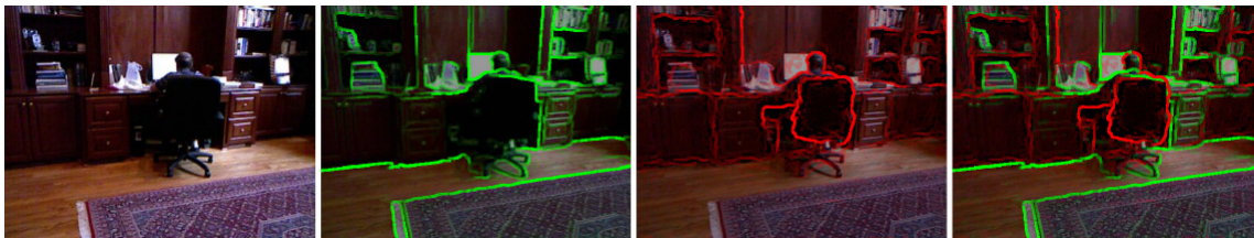
Figura 2.4: De izquierda a derecha: imagen original, límites extraídos de la intensidad de la imagen, límites extraídos de la profundidad, límites resultantes de la fusión de la información RGB y de profundidad
