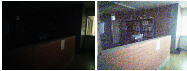
Figura 2.9: De izquierda a derecha: Imagen Original, Imagen aplicando un ecualización de histograma.
