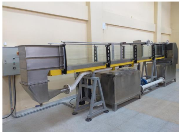
Figura 1.1. Canal de pendiente variable laboratorio de hidráulica UTCH
