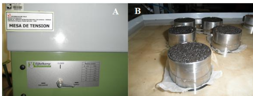
Figura 28. (A) Mesa de tensión en modo de saturación a las muestras. (B) Muestras de suelo saturadas en la mesa de tensión.
