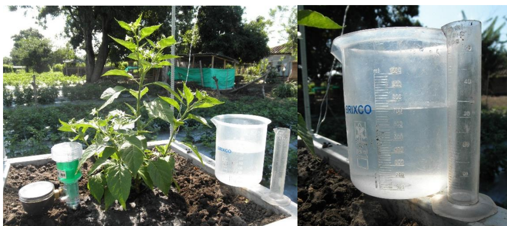
Figura 32. Recipientes utilizados en la aplicación del riego en los lisímetros.
