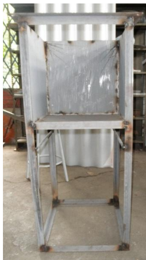
Figura 20. Construcción de los lisímetros en el laboratorio LASA.
