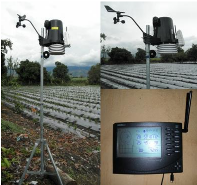
Figura 31. Estación climática portátil instalada dentro de uno de los lotes y Consola receptora de datos de la estación climática.
