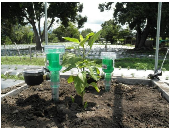
Figura 26. Lisímetro con 2 tensiómetros instalados junto a la planta de ají.
