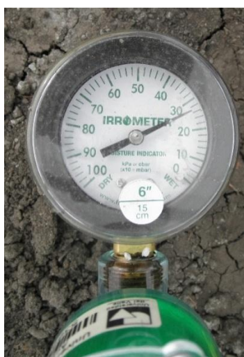
Figura 25. Tensiómetro Irrometer® de 15 cm instalado sobre el lisímetro con medición hasta 100 KPa.
