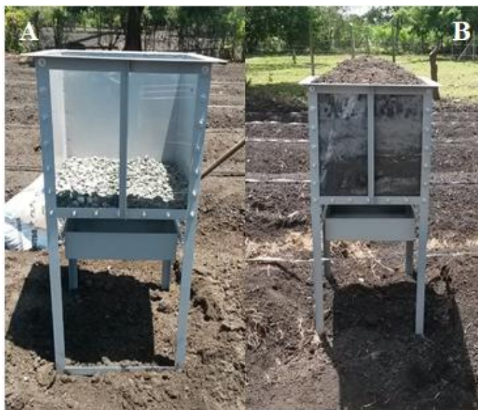
Figura 24. (A): Capa de grava en la capa inferior de los lisímetros. (B): Relleno de suelo en los lisímetros.
