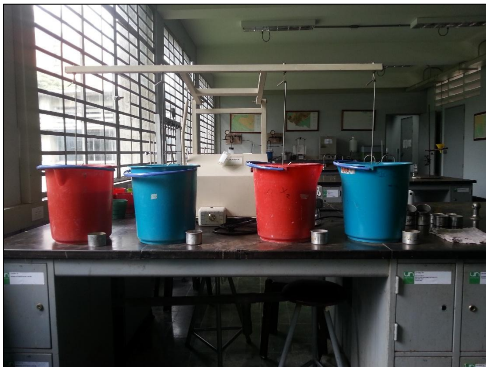
Figura 11. Prueba de estabilidad de agregados, laboratorio de suelos- Nacional –Palmira; Fuente (Autor, 2015)
