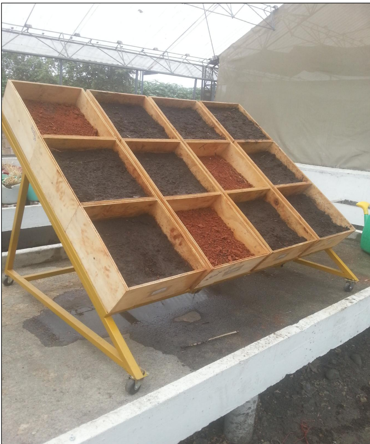
Figura 14. Disposición de las cajas con suelo en el simulador de pendientes; Fuente (Autor, 2015)
