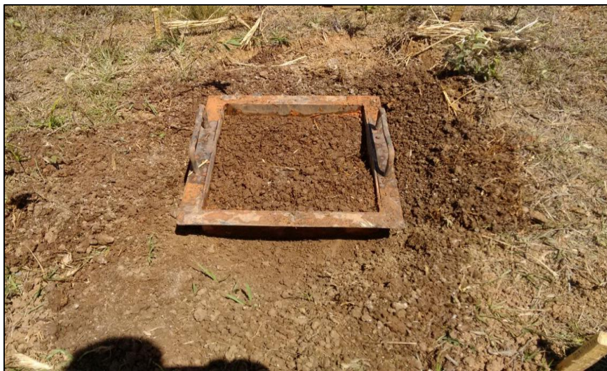
Figura 5. Muestreo del bloque de suelo; Fuente: (Autor, 2014)
