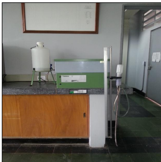
Figura 12. Mesa se arena para porosidad y densidad aparente; Fuente (Autor, 2015)
