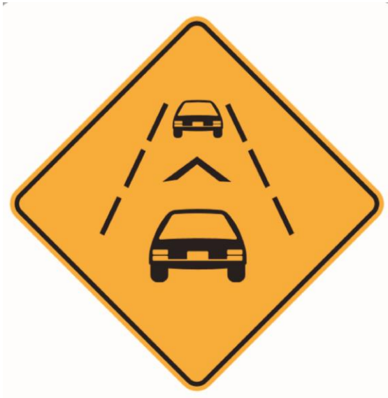
SP-68 Conservar espaciamiento De Señalización Vial-Dispositivos, M. c. (2004)
