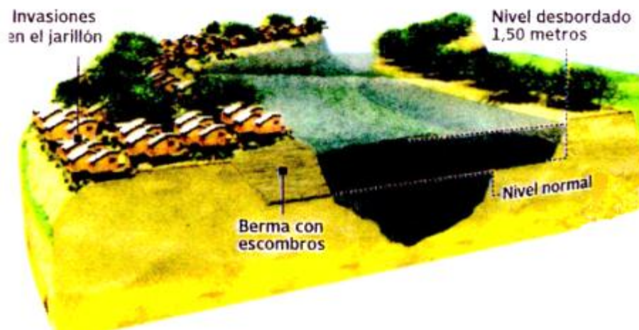
Figura 5: Situación actual del dique del río Cauca en Santiago de Cali
