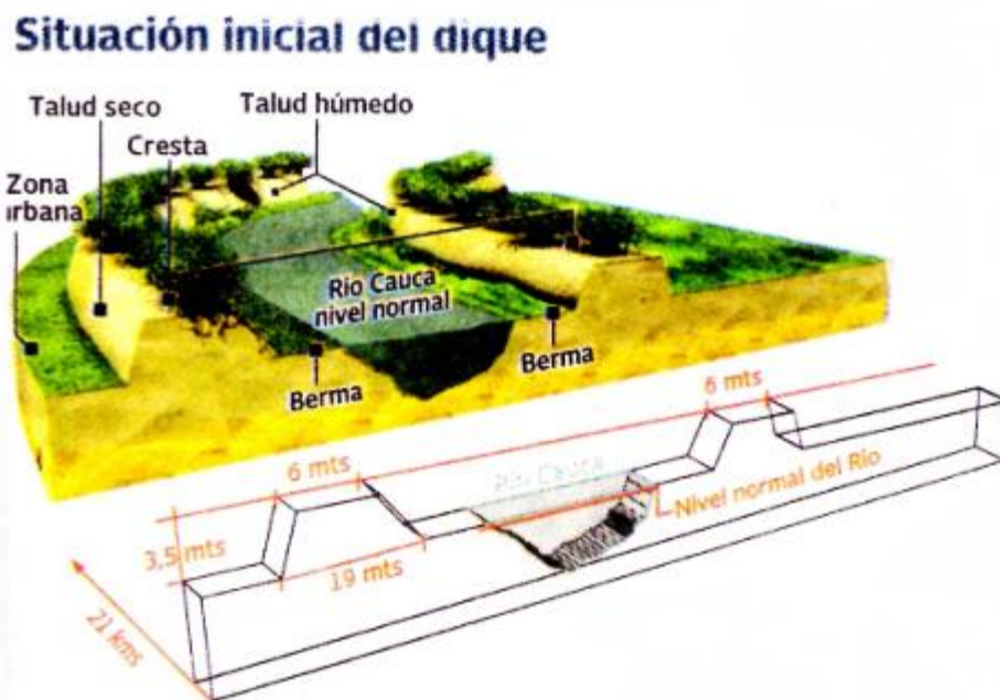
Figura 4: Situación inicial del dique del río Cauca en Santiago de Cali
