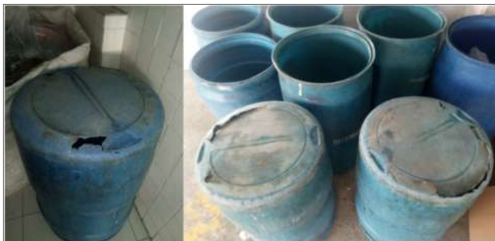
Figura 5. Contenedores plásticos deteriorados
