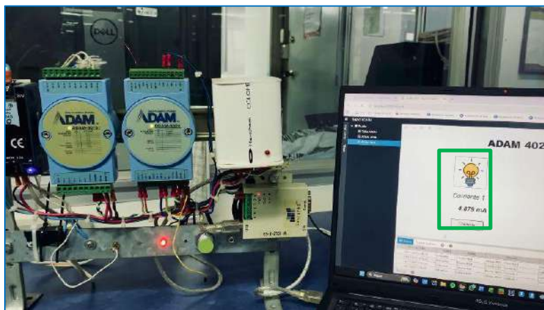
Figura D.1 Respuesta del sistema ante consigna de 5 mA en el módulo ADAM-4024, visualizada en la interfaz Webstation.
