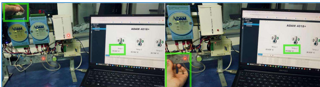
Figura 5.7.1 Validación funcional de la lectura de temperatura en el módulo ADAM-4018+ mediante interacción física con los termopares tipo K.
