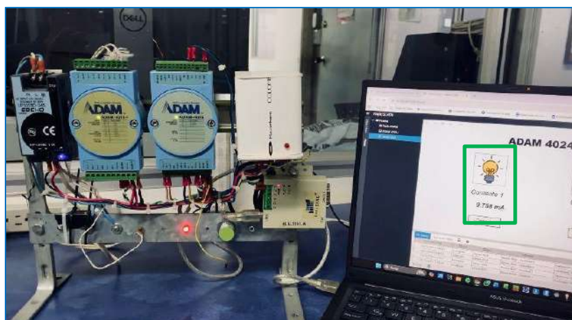
Figura E.1 Respuesta del sistema ante consigna de 10 mA en el módulo ADAM-4024, visualizada en la interfaz Webstation.
