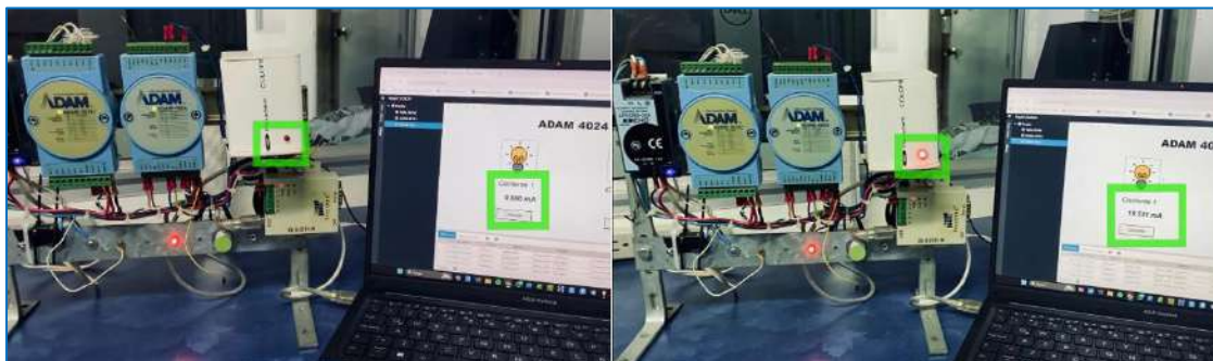
Figura 5.7.2 Validación de la escritura de consignas analógicas en el módulo ADAM-4024 mediante RapidSCADA.
