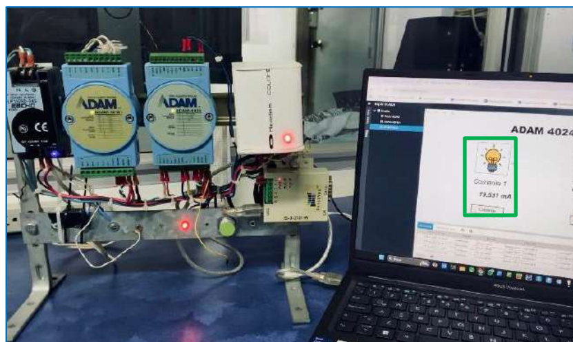
Figura G.1 Respuesta del sistema ante consigna de 20 mA en el módulo ADAM-4024, visualizada en la interfaz Webstation.
