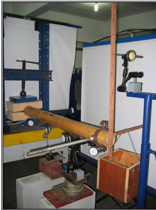
Figura 5.1 Montaje del ensayo de flexo - torsión en la Probeta 2.
