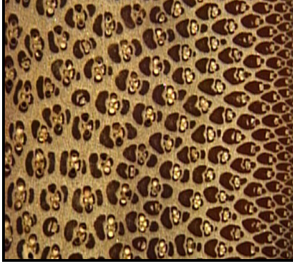
Figura 1.2 Distribución de las fibras en la pared del tallo de Guadua .
