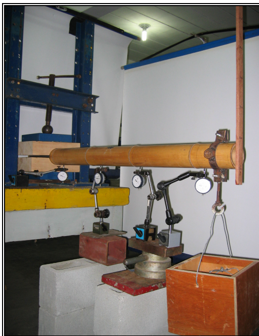
Figura 2.2 Montaje del ensayo de flexión.
