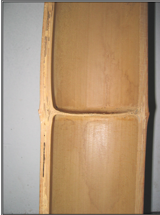
Figura 2.17 Señales de ataque de insectos al interior de la Probeta 2.
