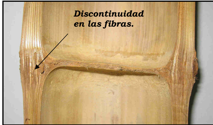
Figura 1.3 Corte longitudinal de un nodo de la especie Dendrocalamus giganteus .
