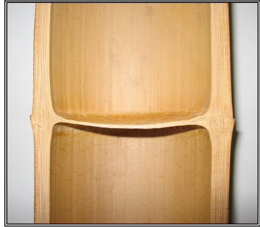
Figura 4.1.b Fotografía de la región nodal correspondiente a la Figura 4.1.a
