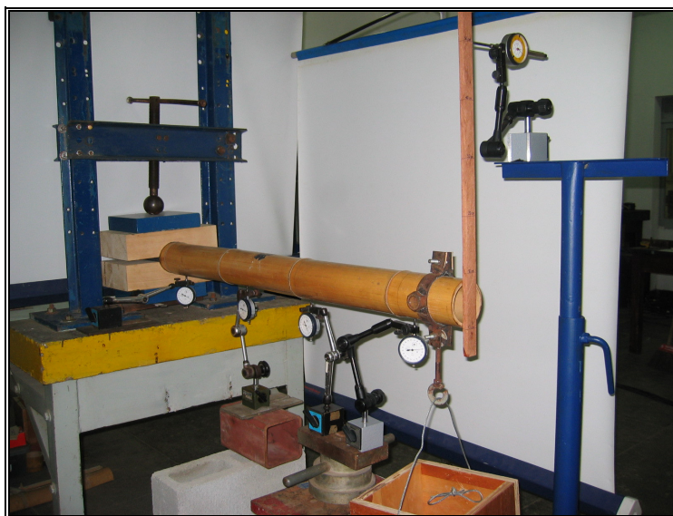
Figura 2.5 Montaje del segundo y tercer ensayo de flexión en la Probeta 2 .
