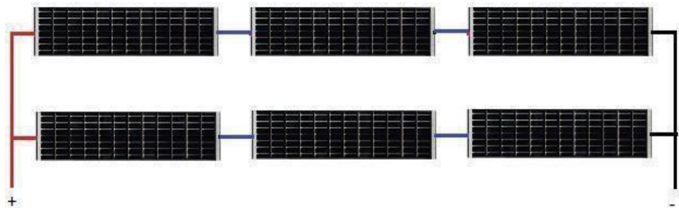
Figura 10. Segundo arreglo de paneles solares
