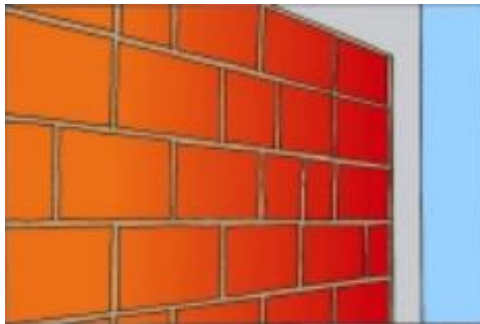
Figura 19. Representación de edificación con vulnerabilidad sísmica media según el tipo y disposición de ladrillos. Fuente: (AIS, 2001).
