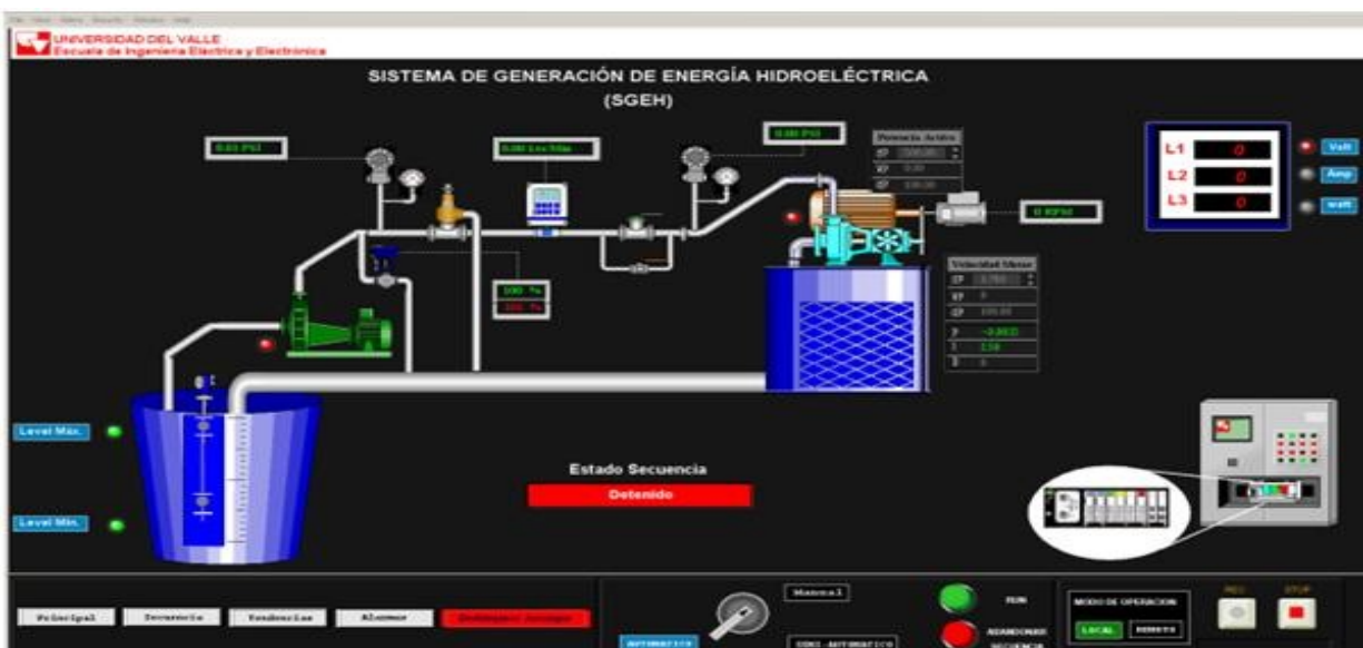
Fig. 5. Panel principal de la interfaz de operador.
