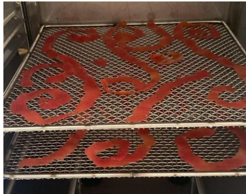
Figura 6. Cáscara de tomate dispuesta en las bandejas del secador asistido por bomba de calor SBC.
