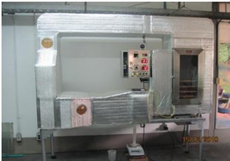
Figura 5. Fotografía del sistema del secador asistido por bomba de calor SBC (Gómez-Daza, 2023).
