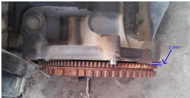
Figura 21. Volante y caja de cambios del auto
