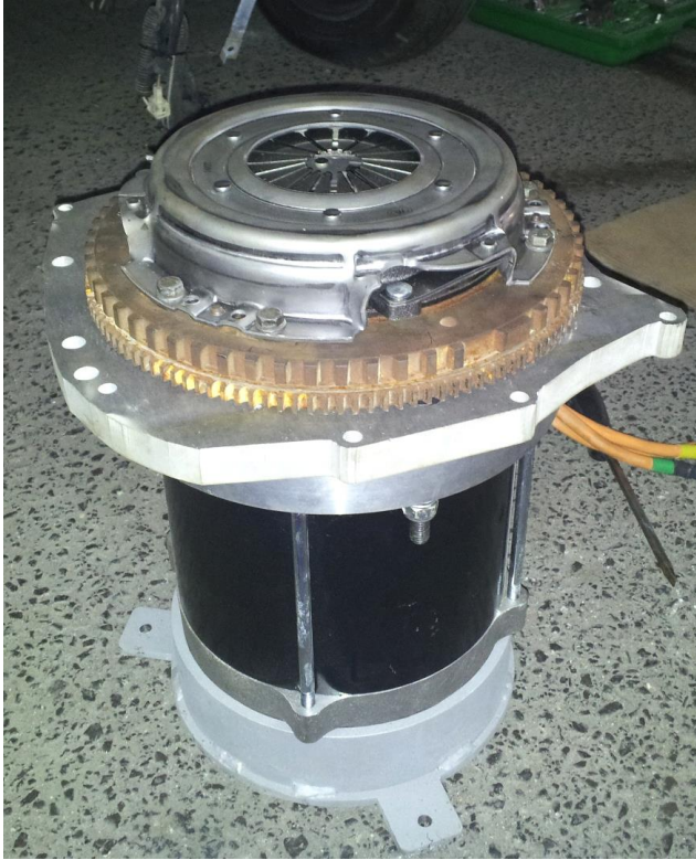
Figura 23. Volante acoplado al motor eléctrico
