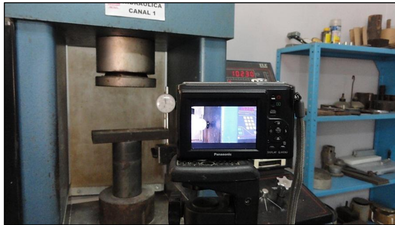
Figura 19. Montaje experimental para registrar la carga y el desplazamiento del cabezal de la máquina
