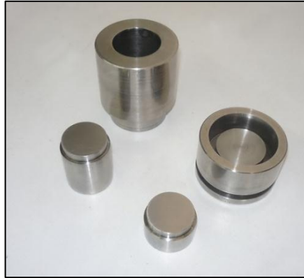
Figura 38. Utillaje construido para la realización del ensayo de compresión de anillo
