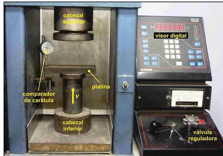
Figura 11. Montaje experimental para registrar el desplazamiento del cabezal inferior
