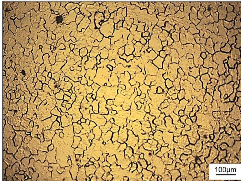
Figura 24. Microestructura de la sección transversal del material base de la aleación AZ31B con tratamiento térmico de recocido. Fotografía a 100 aumentos
