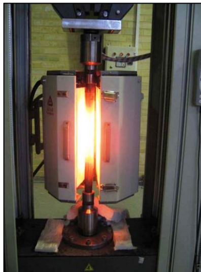
Figura 25. Horno portátil utilizado por Shahriari et al. en el ensayo de compresión de anillo en caliente
