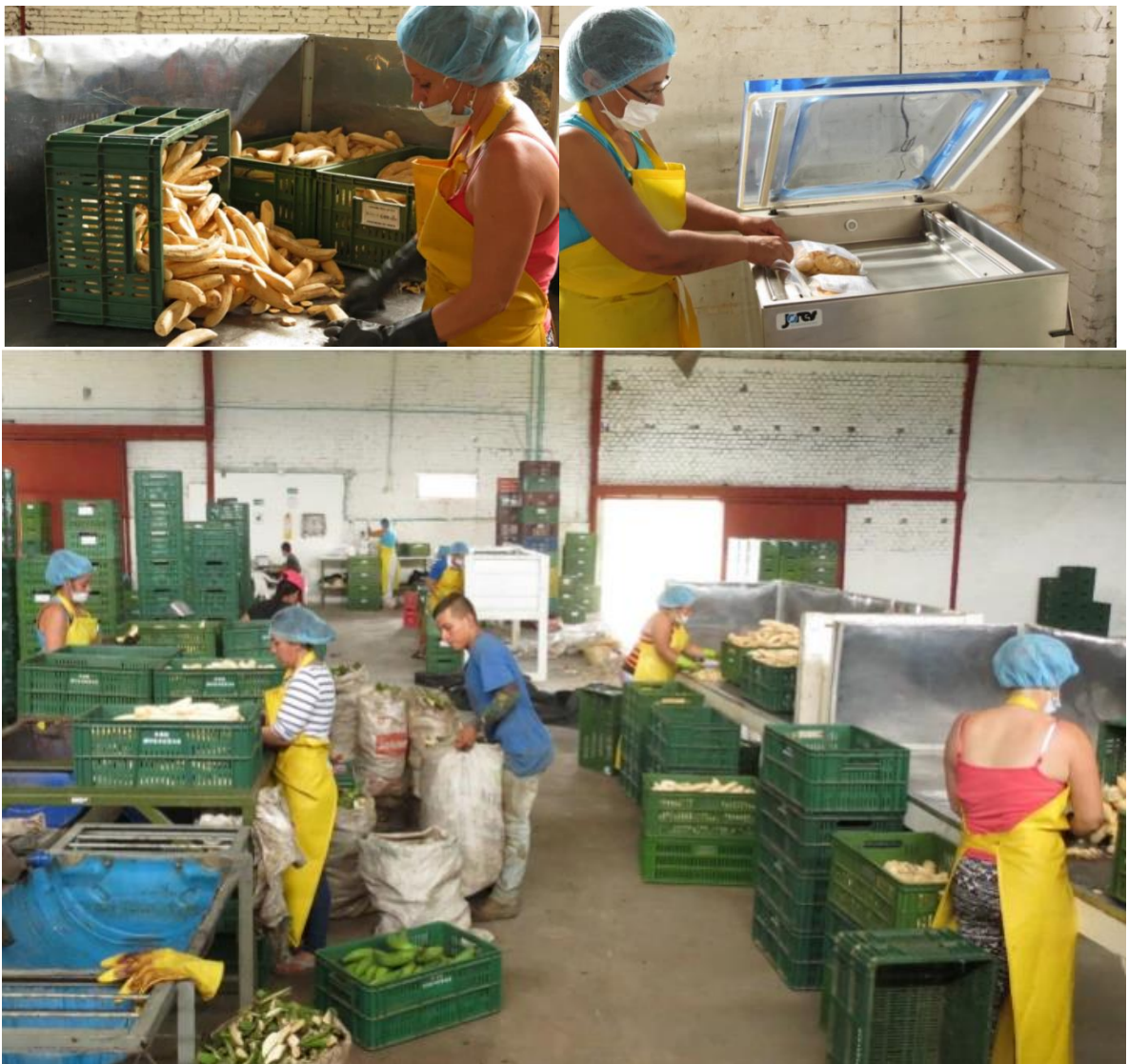
Ilustración 32. Proceso de pelado, lavado y empacado de producto.
