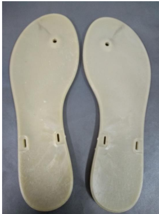
Figura 24. Suelas Inyectadas mezcla P3
