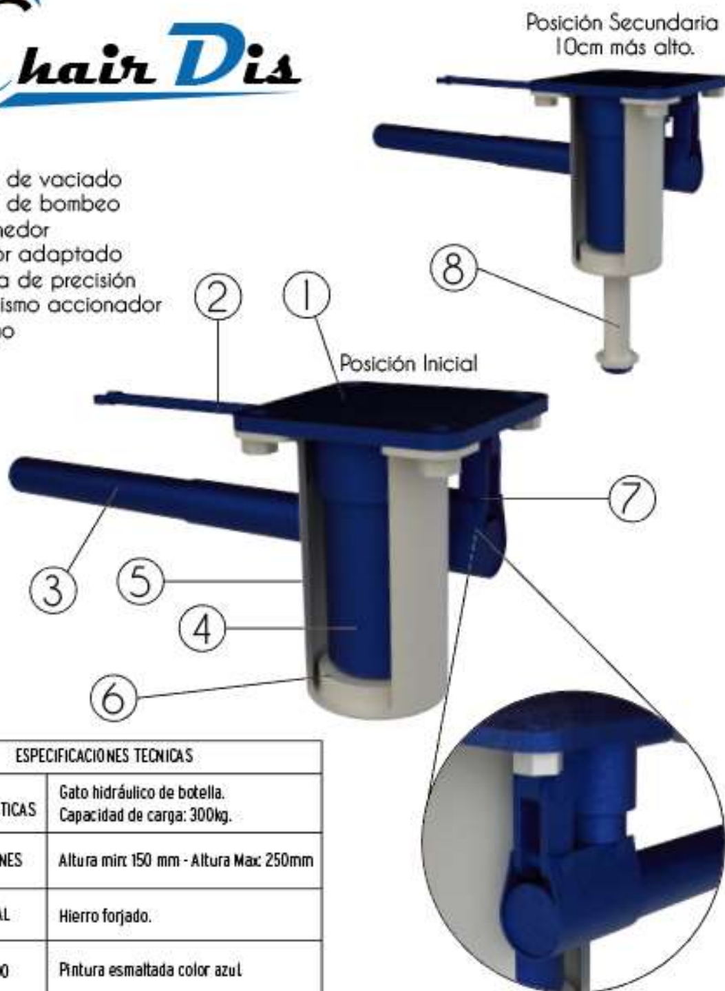
Figura 30. Especificaciones técnicas del gato hidráulico de botella.
