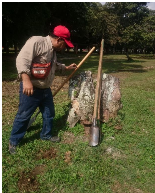
Dagoberto Sinisterra Vargas. Realizando el proceso necesario para trasplantar posteriormente un árbol de Guanábano. La herramienta que se observa, se conoce con el nombre de ahoyador manual. Fecha: 09 de abril del 2018. Univalle. Zona FAI.
