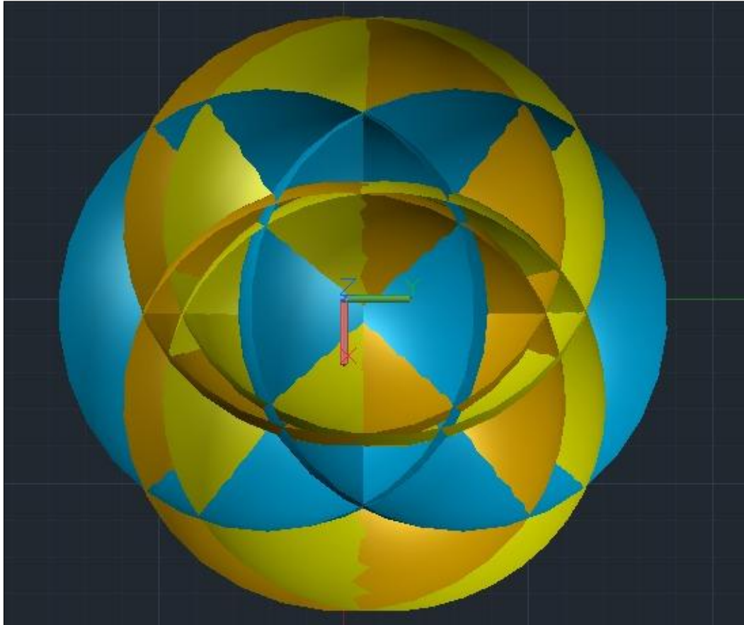
Figura 30. Esferas sobre el sistema de captación.
