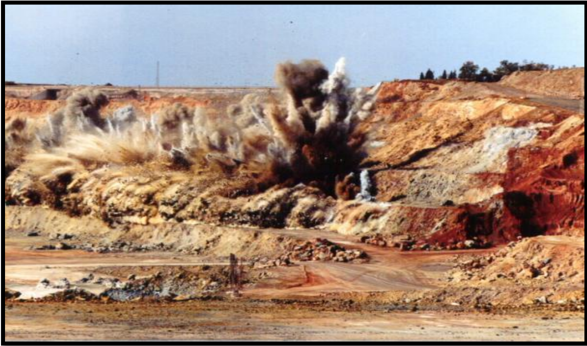
Figura 3. Voladuras para extracción del material en canteras a cielo abierto. Tomado de: Joshep, A. (2012) [En línea].
