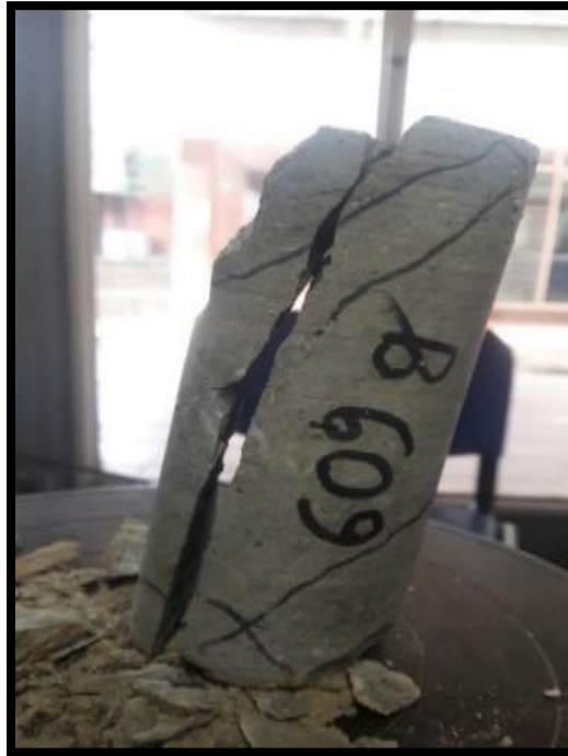
Figura 15. Roca fallada por carga axial. Adaptado de Laboratorio Geología y Mecánica de Rocas (MERO), Universidad del Valle.
