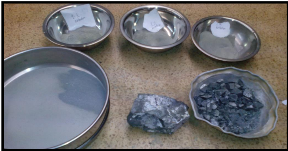
Figura 10. Muestra de basalto empleada para el ensayo. Adaptado de Laboratorio de Geología y Mecánica de rocas (MERO), Universidad del Valle.
