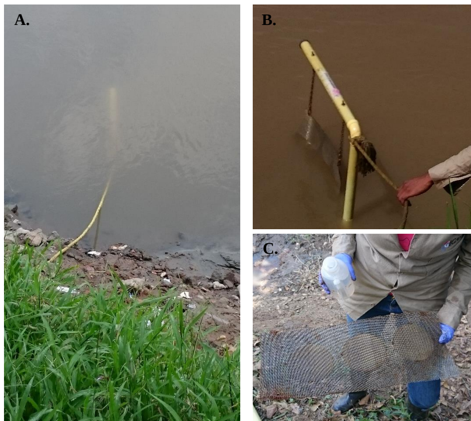
Figura 9. Disposición en campo de los muestreadores GF-EVA. (A) y (B) anclaje al río, (C) muestreadores obtenidos después del tiempo de exposición (25 días).
