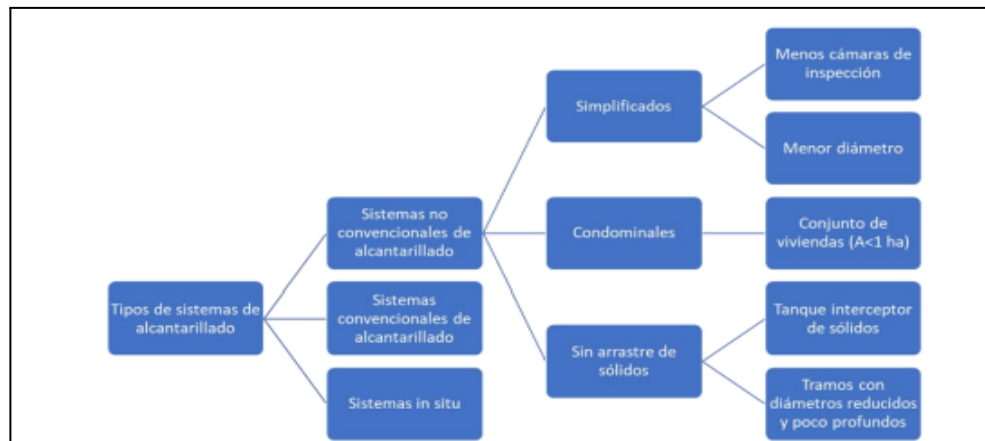
Figura 3 Tipos de Alcantarillados en Colombia
