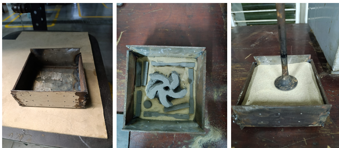
(a) Contenedor metálico fabricado. (b) Ubicación de piezas dentro de contenedor. (c) Piezas cubiertas y levemente compactadas.
