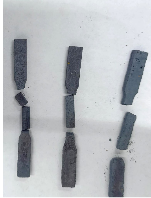
(b) Probetas utilizadas, sin evidencia de deformación plástica.
