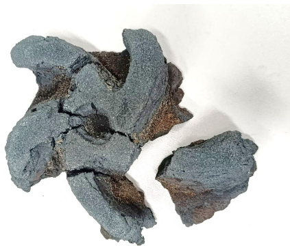
(a) Fragmento desprendido del impeller.
