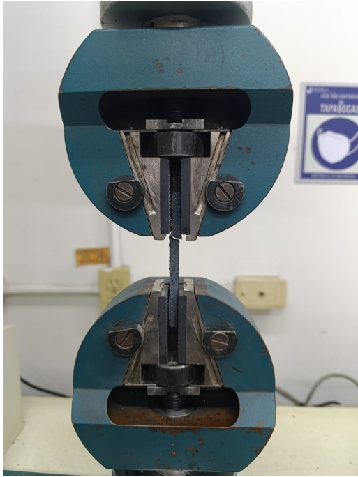
(a) Montaje para ensayo de tracción.
