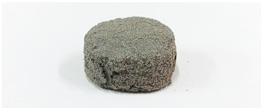
Figura 4.15. Pieza en verde construida para evaluar la adherencia del Silicato en las partículas metálicas.
