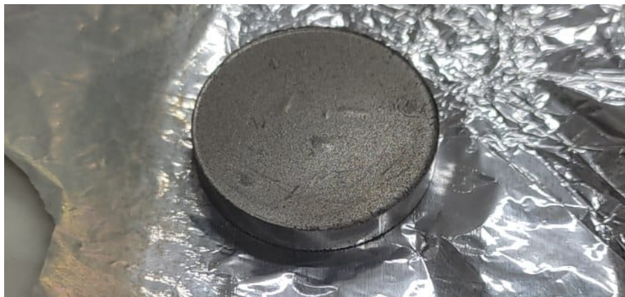
Figura 4.5. Polvo de acero inoxidable martensítico compactado.
