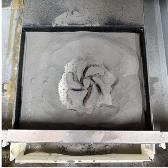
(a) Modelo impreso y seco en la impresora.
