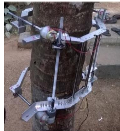
Figura 8: Dispositivo trepador de palmeras autónomo de aluminio. Tomado de [13]
