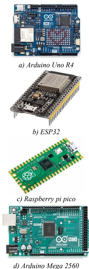
Figura 21: Microcontroladores considerados para el sistema de control.
