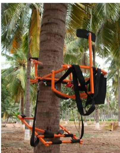
Figura 3: Dispositivo trepador de palmeras ergonómico. Tomado de [9]
