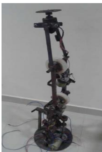
Figura 10: Brazo robótico de cuatro grados de libertad, para la cosecha de cocos. Tomado de [16]
