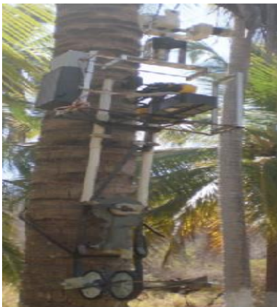
Figura 6: Dispositivo trepador de palmeras biela-manivela. Tomado de [12]
