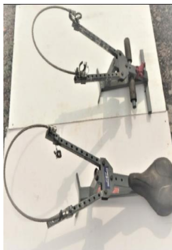
Figura 4: Dispositivo trepador de palmeras "sit and stand". Tomado de [10]
