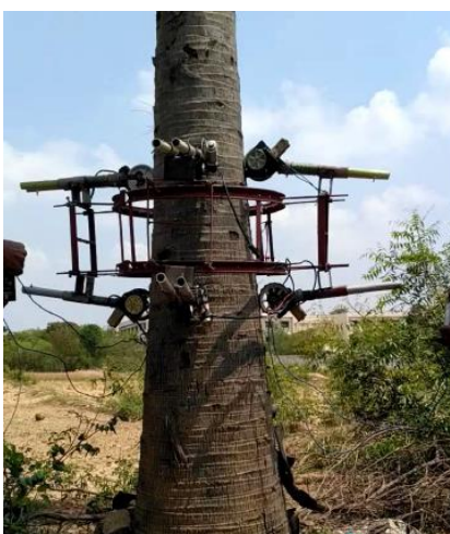
Figura 9: Dispositivo trepador de palmeras autónomo. Tomado de [15]
