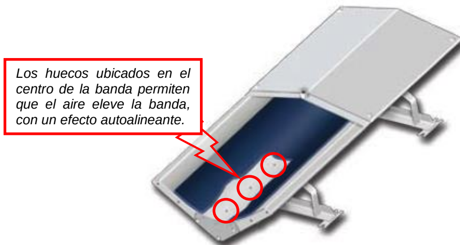
Figura 5. Huecos sobre la línea de centro de la banda. Fuente: MARTIN ENGINEERING. FOUNDATIONS
