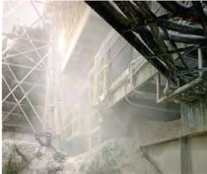
Figura 2. Polvo en el ambiente ocasionado en transportadores de banda Fuente: Foundations 6ª Ed. Autor: Martin Enginnering Inc
