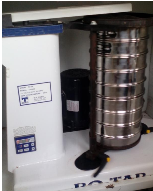
Figura A5. Ro- tap y serie de tamices TYLER
