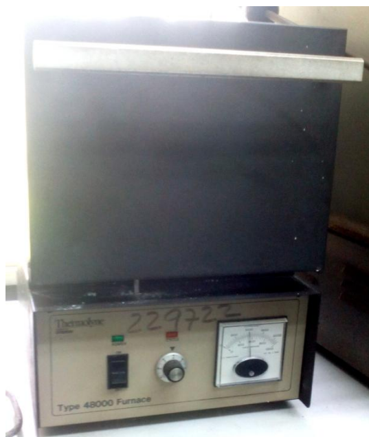
Figura A1. Mufla para incinerar muestras
