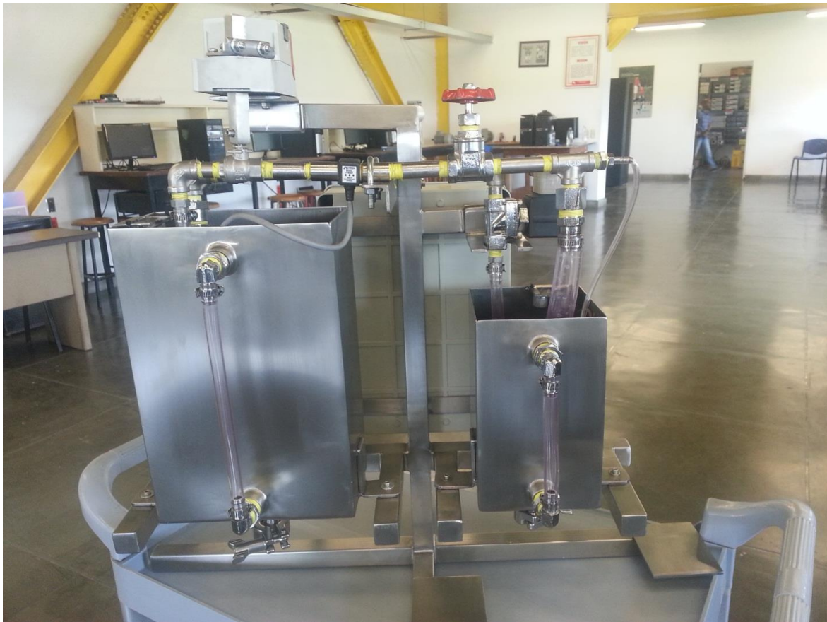
Figura 1. Planta de Control de Llenado de Líquidos
