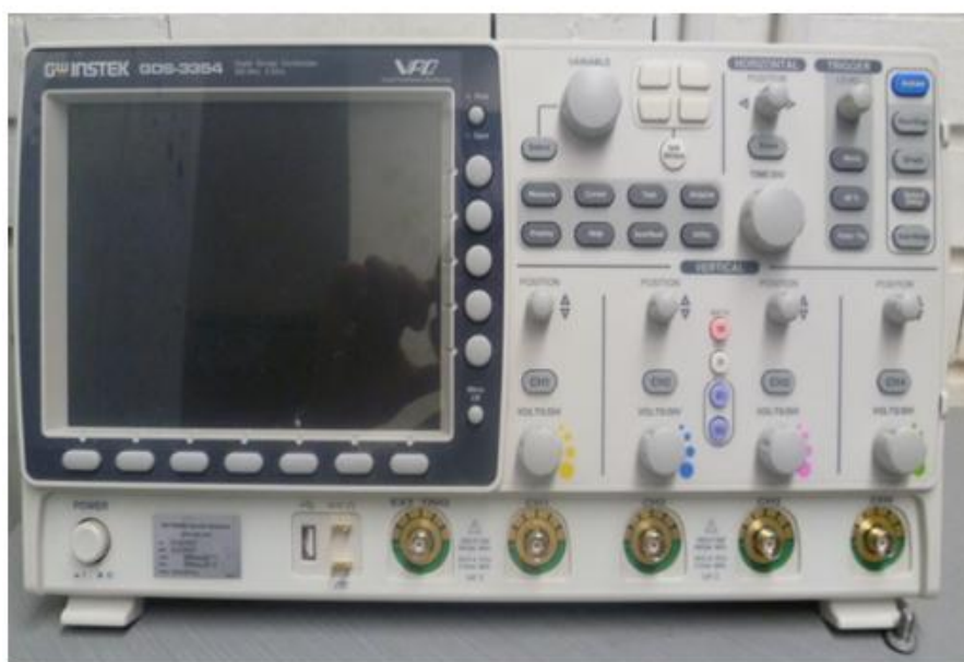
Figura 55. Osciloscopio implementado durante el ensayo de cortocircuito franco
